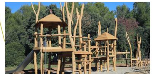
Au soleil, privilégier du mobilier urbain en bois, peu émissif, donc sans sensation de chaleur ni danger de brûlure. Dans les structures de jeux, attention au toboggan en métal qui peut être très chaud.
